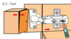
THIS SCREW IS FINE TURNING TO ADJUST THE DOOR MOVING FORWARD / BACKWARD
