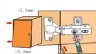
THIS SCREW IS FINE TURNING TO ADJUST THE ALIGNMENT BETWEEN THE DOOR AND THE DOORFRAME
